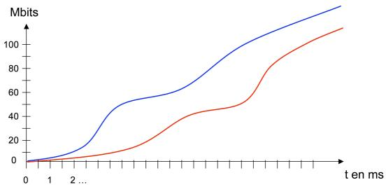
Dans le schéma ci-dessus, il est représenté la courbe du trafic en entrée du lien Pau-Paris et la courbe du modèle de service de l'opérateur Equant sur ce lien. (0.25)Indiquez quelle courbe est logiquement celle du modèle de service de l'opérateur Equant. (0.75)Dans ce schéma pouvez-vous rapidement dire si le délai maximum de 8ms pour une application de calcul distribué pourra être respecté ? Faites un dessin sur le schéma montrant la manière dont vous avez procédé.
