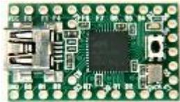
le Teensy, ne fait pas proprement partie des cartes Arduino, mais on peut le programmer à partir de l'environnement Arduino. Son processeur est plus puissant, les E/S sont plus nombreuses, il est minuscule et on peut disposer d'un interface USB MIDI natif...
